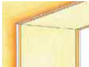
Lijepljenje elementa bočnog zida sredstvom Körapur 572
