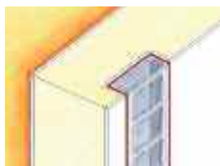
Lijepljenje vodilice za utovar u dvije razine sredstvom Körapur 140
