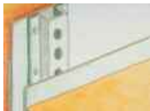
Brtvljenje zakovanih profila sredstvom Ködiplast CS
